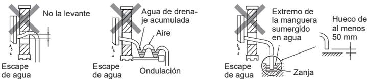
No coloque el tubo de drenaje directamente en una zanja de drenaje donde pueda generarse amoníaco o gas sulfúrico. El gas corrosivo evaporado podría volver al lado interior a través del tubo de drenaje y provocar un olor desagradable y corrosión en el intercambiador de calor.
