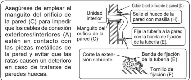
Después de la prueba de fugas, aplique material aislante de modo que no queden huecos.
